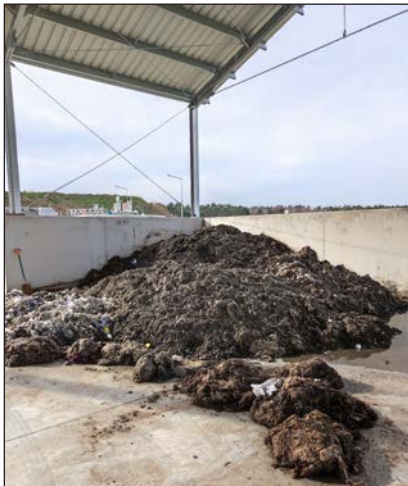
Hałda skrątek pozyskana ze ścieków na oczyszczalni w Dopiewie
